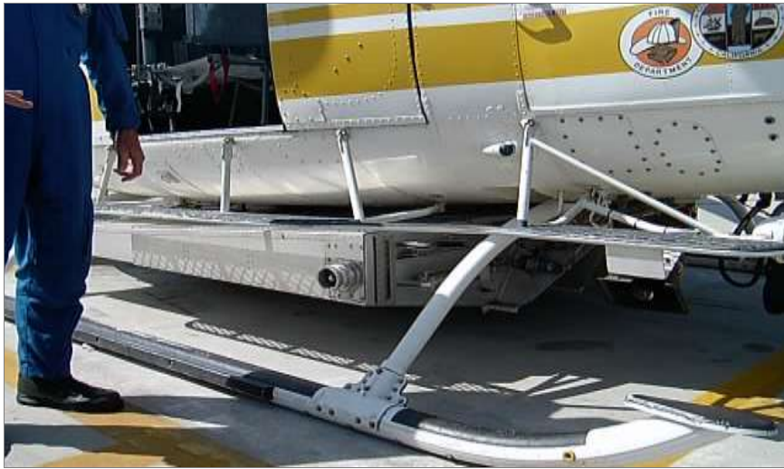
1. kép Bell 412 aljához rögzített merev tartályos megoldás, USA fotó: Krizsán Lajos
